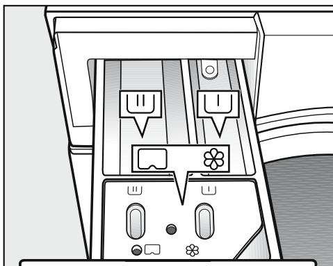
■ Выдвиньте отсек для моющих средств и добавок и заполните ячейки моющим средством.
