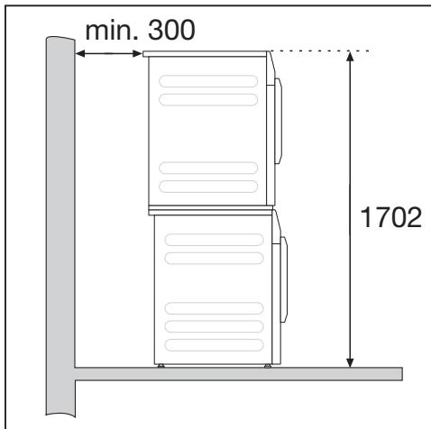
Стиральная машина может устанавливаться в колонну с сушильной машиной Miele. Для этого необходим соединительный комплект (дополнительно приобретаемая принадлежность).
