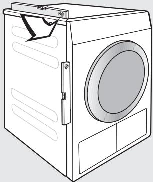
Для обеспечения безупречной работы этой сушильной машины требуется её установка в вертикальном положении.
