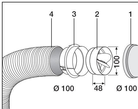
① Подключение к коллектору системы вытяжной вентиляции
