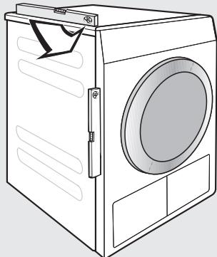
Для обеспечения безупречной работы этой сушильной машины требуется её установка в вертикальном положении.
