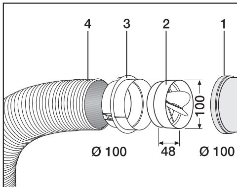
① Подключение к коллектору системы вытяжной вентиляции
